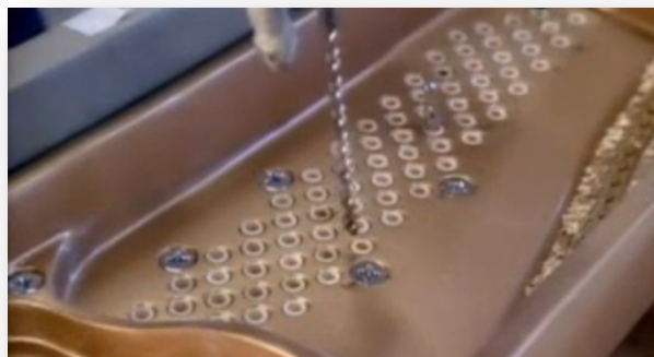
Un treballador forada el claviller a través del bastidor.
